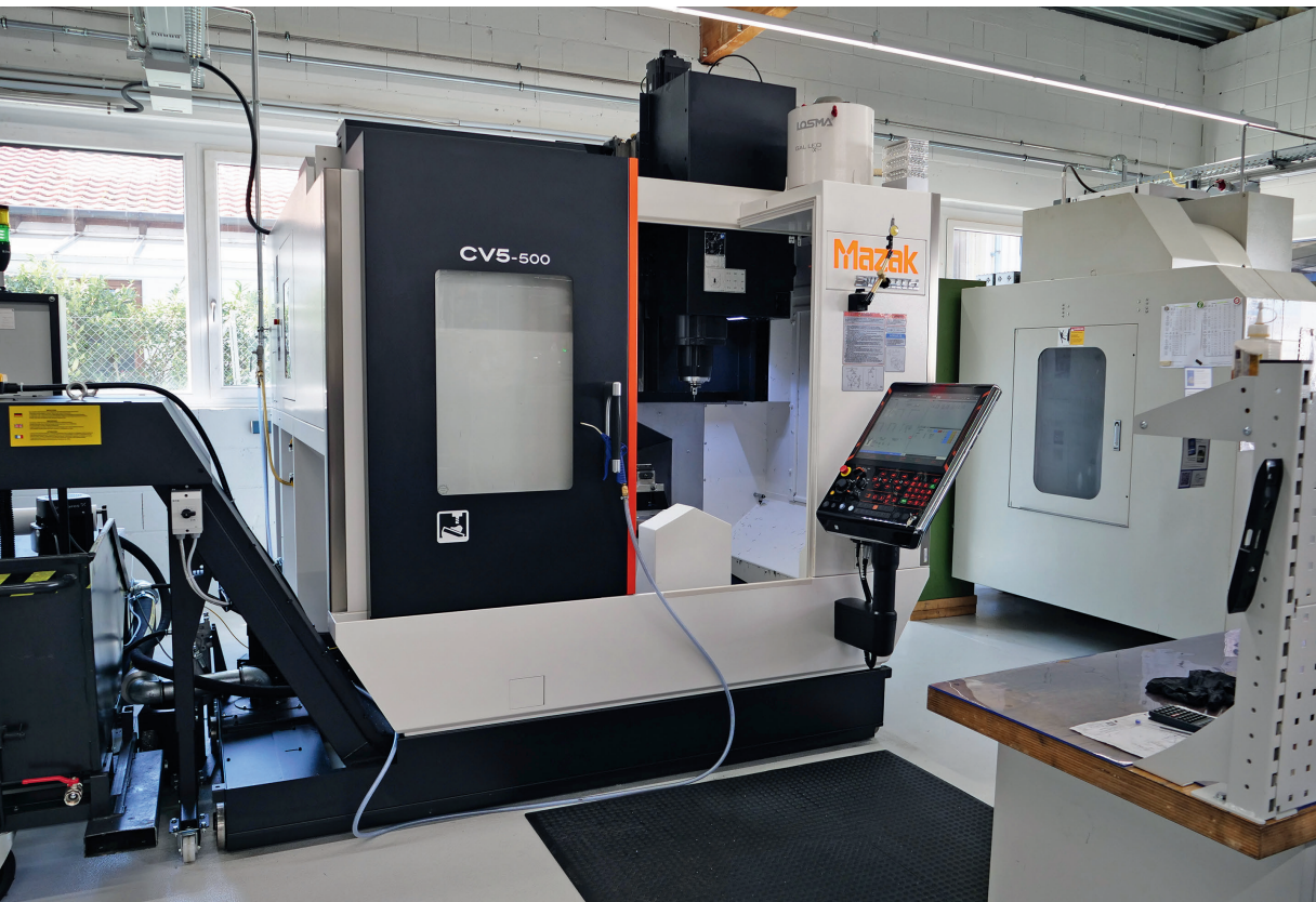
1 Das aktuelle Highlight in der Fertigungshalle von Winter Präzisionstechnik: Das 5-Achs-Bearbeitungszentrum Mazak CV5-500 besticht neben seiner hohen Genauigkeit auch durch eine kompakte Konstruktion. Es lässt sich zudem bei Bedarf leicht automatisieren © Andrea Jäger
